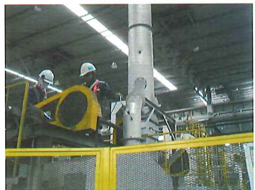
รูปที่ 6 ภาพแสดงการตรวจวัดประสิทธิภาพการเผาไหม้ เตาชุบความร้อน
