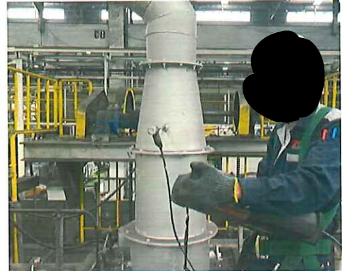
รูปที่ 4 ภาพแสดงการตรวจวัดประสิทธิภาพการเผาไหม้ เตาชุบความร้อน
