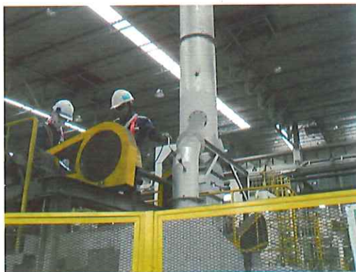
รูปที่ 3 ภาพแสดงการตรวจวัดประสิทธิภาพการเผาไหม้ เตาชุบความร้อน
